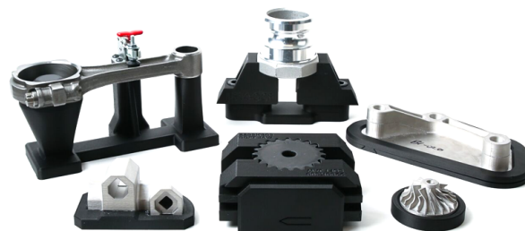
(図4) 工業用3Dプリンタで作ったパーツ例
